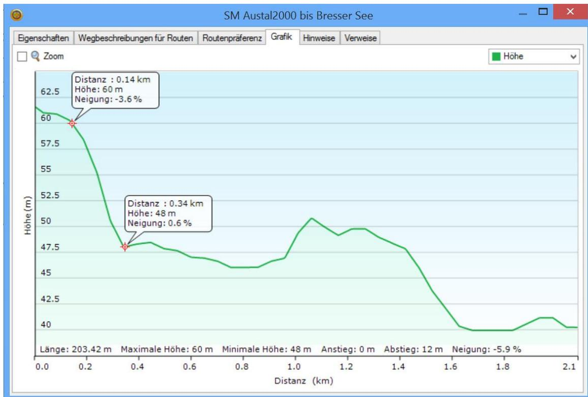
Abbildung 6.6.3.1: Höhenprofil von der Schweinemastanlage zum Bresser See. Das Höhenprofil wurde erstellt mit Garmin BaseCamp 4.4.7 auf der Basis von TOPO Deutschland V6 PRO. Der Punkt SM Austal2000 hat die Koordinaten (4 508642/5947542), die als Parameter bei den Berechnungen im Programm Austal2000 eingegeben wurden. Der Punkt Bresser See ist die Südspitze des Bresser Sees (4 508580/5949623).
